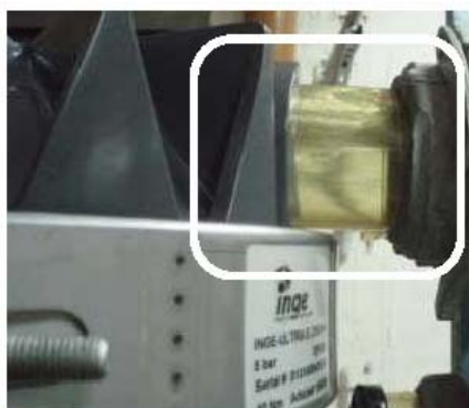
Рисунок 5-1: Мониторинг целостности модуля через прозрачный патрубок на верхней и нижней торцевой крышке (модули dizzer 3000 plus/5000 plus)
